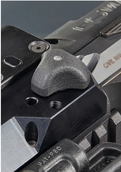
Links die auf dem Picatinny-Querstift sitzende dreiflügelige Schraubenmutter der Sekundär-, rechts die zweiflügelige der Primärklemmung.
