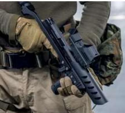
hördlicher Anwendung). Insgesamt vier Picatinny-Schienen sind integriert: oben, unten und jeweils an der Seite des Systems. Hinzu kommt ein Mündungsfeuerdämpfer, der auch abmontiert werden kann.
