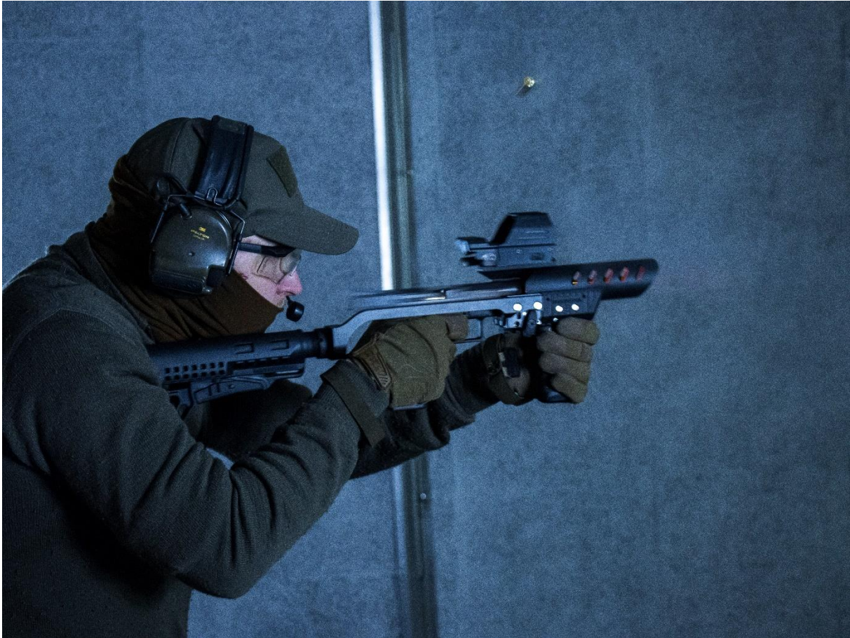
Bild 3: Das Anschlagschaftsystem „Odin II“ ist eine Systemlösung zwischen Pistole und Maschinenpistole. Dabei ergeben sich hinsichtlich dem „Wettbewerber“ 10 Maschinenpistole etliche Vor- und nur wenige Nachteile. Der Hochschlag war nicht auffälliger als bei einer ungleich schwereren Maschinenpistole, was an Bauform und Ausstattung des Anschlagschafts liegen dürfte. (Das Bild zeigt dabei nur eine Konfiguration, die beim Expertentreffen in Bayern genutzt wurde.) (Foto: Donaustahl GmbH)
