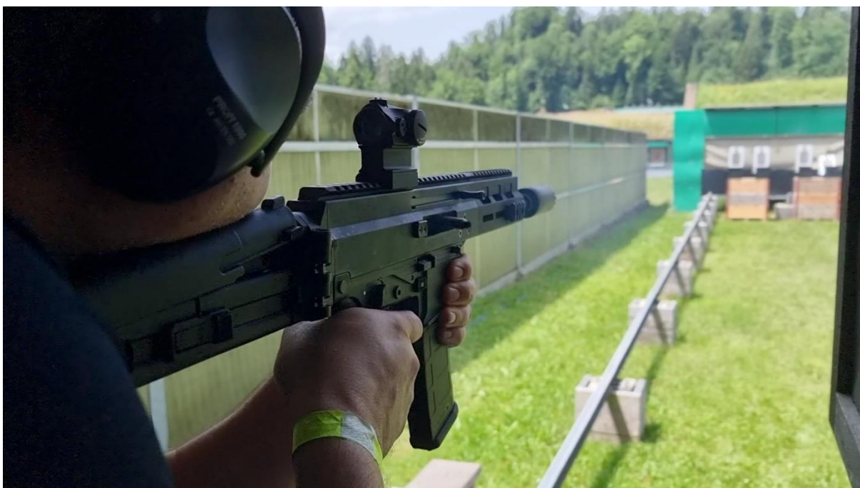
Bild 2: Wesentlich weniger Hochschlag: eine Mitteldistanzwanne (Modell APC556 der Firma B&T) im Kaliber 5.56mm x 45, ausgestattet mit Rotpunktvisier und Schalldämpfer. Das höhere Gewicht (hier: ca. 3,5kg) macht sich entsprechend bemerkbar. Nachteil: die Wanne wird schneller „unbequem“, d.h. der Schütze fängt aufgrund des höheren Gewichts früher an zu zittern und zu wackeln. (Foto: Stephan G. Humer)
