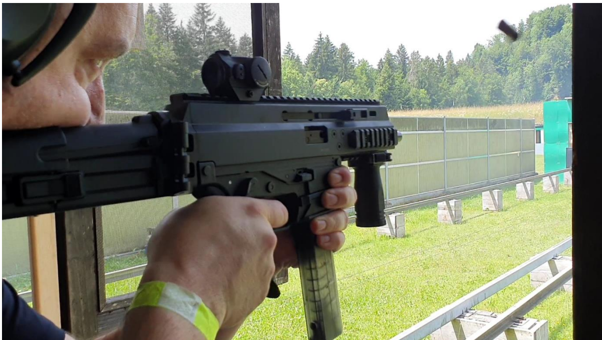
Bild 1: Problem aller „kleinen“ und „leichten“ Waffen: der vergleichsweise starke Hochschlag. Eine Maschinenpistole bietet hier meist Vorteile gegenüber einem Anschlagsschaft, v.a. aufgrund von Gewichts- und Funktionsunterschieden. Im Bild gut zu sehen: der leichte Hochschlag der vom Gutachter geschossenen Maschinenpistole APC9 (Gewicht: ca. 2,8 kg). Die Waffenachse war vorher parallel zur Oberkante der Lärmschutzwand. (Foto: Stephan G. Humer)
